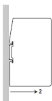
Для демонтажа шлюза нажмите на верхнюю часть шлюза и потяните шлюз от DIN рейки за нижнюю часть шлюза как показано на рисунке.
